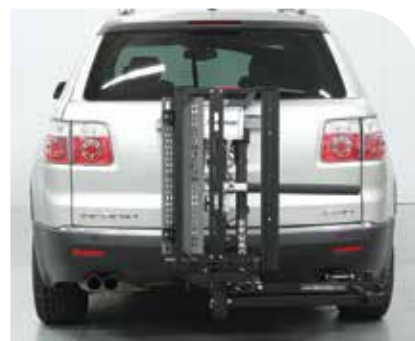
La plateforme HTP convient aux fauteuils motorisés à traction médiane dotés de roues de 10 po (25,4 cm) ou de 14 po (35,6 cm).
