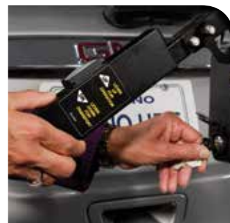
Commande à un bouton et loquet de sécurité intégré pour prévenir l'abaissement accidentel de la plateforme.
